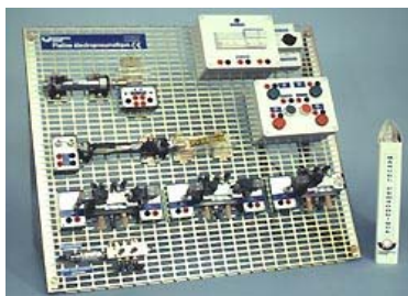
Câblage sur platines pneumatiques
